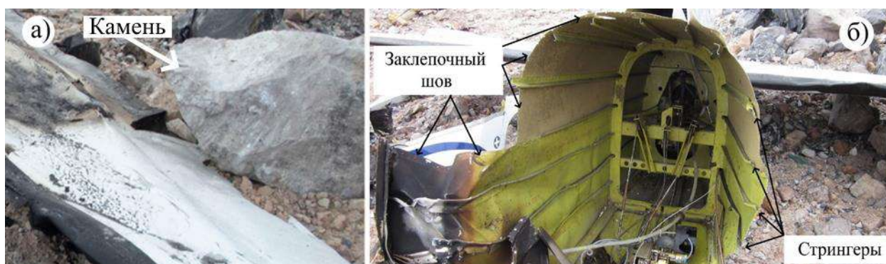
Рис. 8. Вид: камня – а), разрушения и деформаций элементов силового набора хвостовой части ВС – б)
