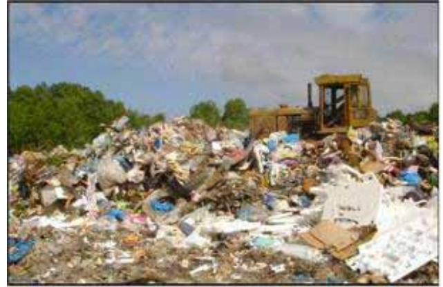
Լուսանկար 2. Աղբանոցում աշխատող բուլդոզերը հարթեցնում է բեռնաթափված թափոնները
