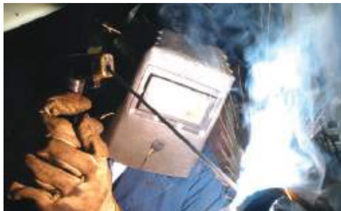
Նկար 22. Եռակցումը աղեղի/պարպման միջոցով:
