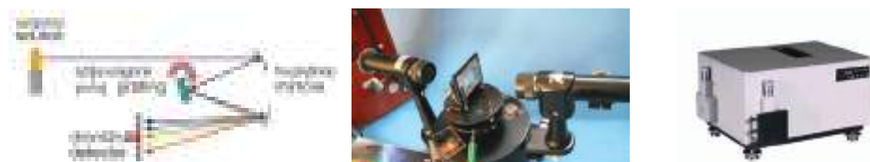
Նկար 36. Դիֆրակցիոն ցանցով սպեկտրոմետր՝ սարքի սխեմատիկ, կառուցվածքային և ամբողջական պարկերները:
