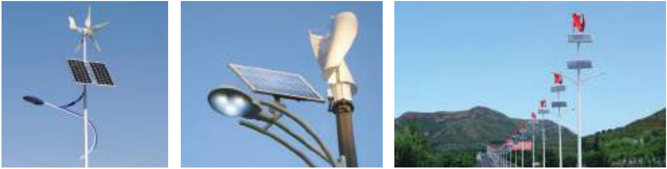
Նկար 16. Արեգակնային և հողմային էներգիաների օգտագործման համադրությամբ ԼԴ փողոցային լուսավորության օրինակներ:
