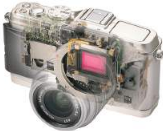
Նկար 17. Իրական խցիկի ներքին կառուցվածքը:
