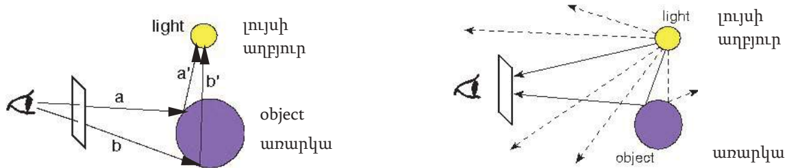
Նկար 9. ա) ճառագայթի հետադարձ հետազոծում; բ) ճառագայթի ուղիղ հետազոծում
