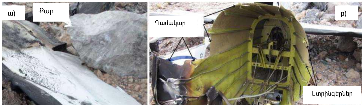
Նկ. 6. Տեսակը. քարի՝ ա), ՕՆ-ի պոչամասի ուժային հավաքածուի տարրերի քայքայումների եւ դեֆորմացիաների՝ բ)
